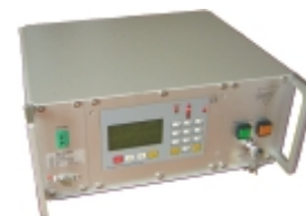
externe Temperaturregelung THERMCON mit kundenspezifischen Pyrometer
