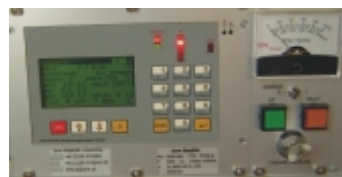
interne Temperaturregelung THERMCON
