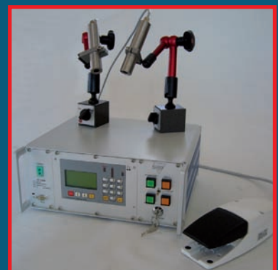
Temperaturregelung THERMCON ZWEIPUNKT PYROMETER TECHNIK
