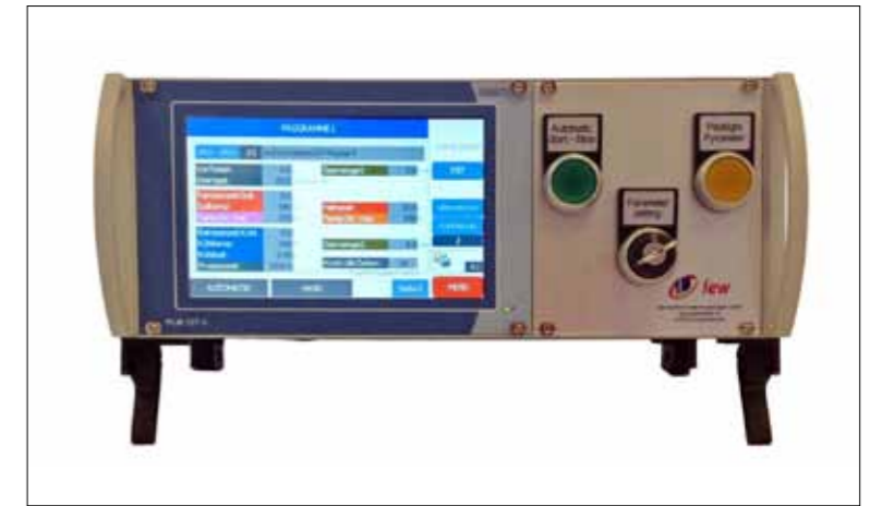
SPS Ablaufsteuerung zur Temperaturregelung
