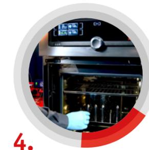
4. Trocknen im Vortrocknungsöfen für 30-60 Minuten bei 100 °C
