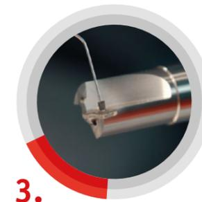
3. Platzieren der zu fügenden Schneide(n) am Werkzeug
