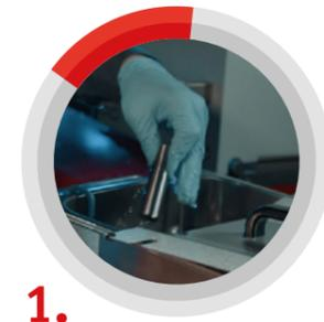
1. Reinigen der Bauteile z.B. im Ultraschallbad
